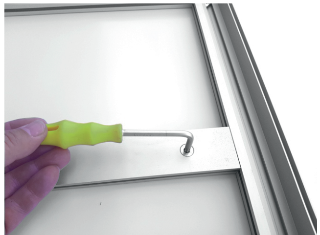
#6 Mit Torx Schlüssel das Spannschloß schließen
