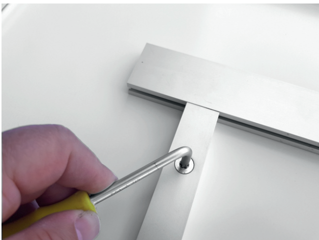
#7 Einsetzen einer Kreuzverstebrung (schematisch)
