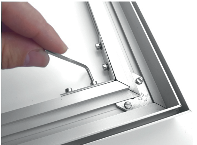
#4 Anziehen der Innen liegenden Schrauben mit Inbusschlüssel
